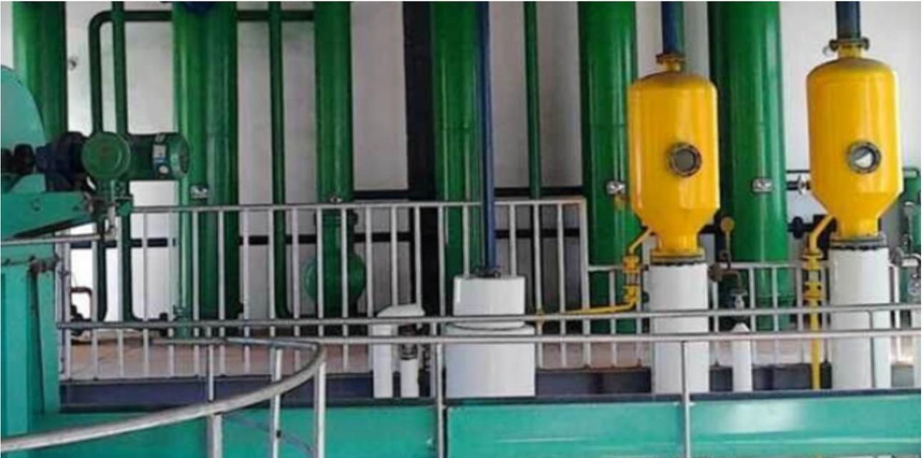
油脂精炼方法分为：机械法、化学法、物理法。主要过程：过滤、水化（脱胶）、中和（脱酸）、吸附（脱色）、冷冻（脱蜡、脱硬脂）、蒸馏（脱臭）等。工艺分类：根据油料的不同、毛油的制取工艺不同、客户对成品的要求不同、处理量的大小不同和精炼的方法不同，我公司的精炼设备分为三种：间歇式精炼设备、半连续式精炼设备、全连续式精炼设备。油脂精炼工艺讲解：磷脂脱磷：首先介绍一下什么是磷脂，磷脂是一类结构和理化性质与油脂相似的类脂物，成胶体状态存在。游离态的磷脂较少。一般原油中含量为1-3，主要表现为受热已形成泡沫。继续受热会焦化变苦并导致油色加深，当油中有水存在时，会吸水膨胀、凝聚而从油中析出。使得油脂的色泽浑浊变深。再碱炼过程当中会增加含油量，一次通常要将其从油脂中去除。物理精炼一般采用盐水脱磷，不同的油规定的磷脂指标也不尽相同，具体按规定的油脂标准而定。
