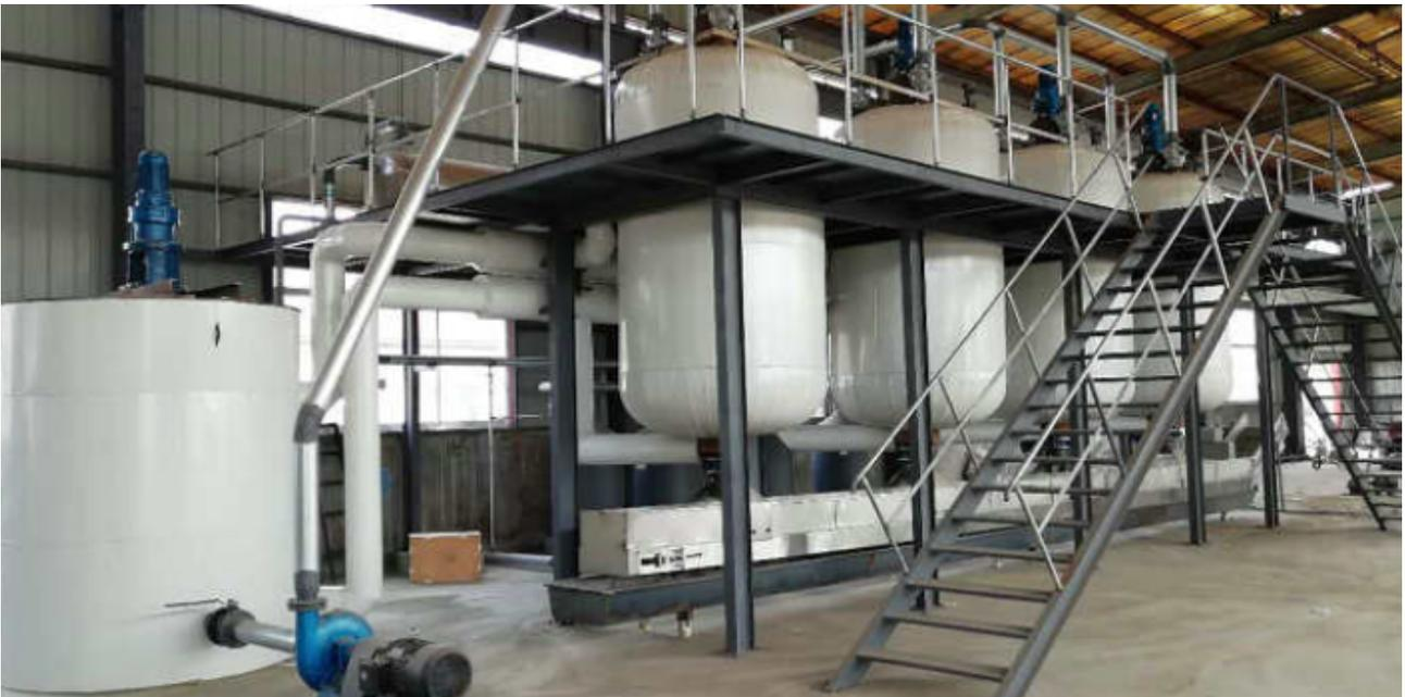
脱胶工艺:脱胶原油中的胶溶性杂质的工艺过程称之为脱胶。脱胶的方法有多种, 入水化脱胶、低温脱胶、酸炼脱料、吸附脱胶等, 油脂工业上应用普遍的是水化脱胶。利用磷脂等胶溶性杂质的亲水性, 将一定量的稀碱、食盐、磷酸等电解质水溶液, 在一定条件下加入到原有中, 是其中的胶溶性杂质凝聚并沉降分离的脱胶方法, 称之为水化法。脱色工艺: 脱色就是为了去除油脂里边的色素, 如果要到一级油的话, 油脂脱色的方法有很多, 常见的油吸附法脱色、加热脱色、氧化脱色等, 生产中应用\*\*\*的是吸附法脱色。吸附法脱色是利用较强选着性吸附作用的物质(如白土、漂土、活性炭等吸附剂), 在一定条件下吸附油脂中的色素及其其他杂质。起到脱色的目的。海南九成新油脂设备生产厂家出油率高, 选购就选德行二手设备。
