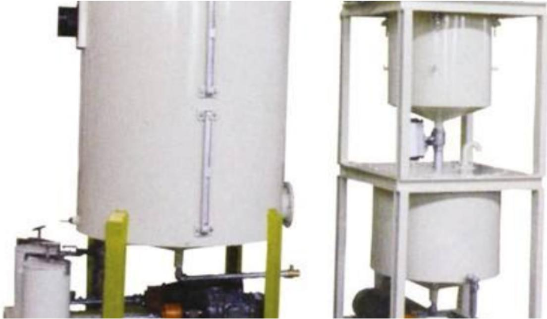
精炼油设备工艺流程图：脱酸。是脱除毛油中游离脂肪酸。这是整个精炼过程中关键的阶段。脱酸的方法很多，应用\*\*\*的是碱炼法，即采用碱来中和游离脂肪酸，使游离脂肪酸生产肥皂从油中分离析出。脱色。采取吸附脱色法除去毛油中的色素、微量肥皂、磷脂、多环烃、残留农药。脱臭。脱臭不仅可以除去毛油中的臭味物质，提高油脂中的烟点、改善油的风味，还能有效除去污染，同时还能除去过氧化物及其分解产物，除去霉烂油料中的蛋白质挥发性分解物，除去小分子量多环芳烃等残留农药，使之降至安全程度内。毛油脱臭就是在高真空的饿状态下，水蒸气通过含臭味组分的高温油脂，气—液表面接触油中的臭味组分挥发到水蒸气泡中，并按其分压的比率随水蒸气一起逸出，以达到除臭目的。脱腊：是根据腊与油脂的熔点差及腊在油脂中的溶解度（或分散度）随温度降低而变小的性质，通过冷却析出晶体腊，经过滤或离心分离而达到脱腊的目的。脱腊诸法的一个共同点，就是温度在25℃以下，才能取得好的脱腊效果。选购油脂机械设备-产品优良质量可靠。重庆饲料油脂设备生产厂家
